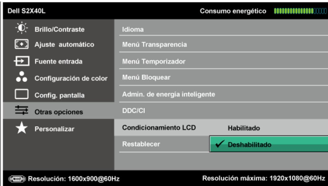
Si parece que una imagen permanece en el monitor, seleccione **Acondicionamiento de la pantalla LCD** para ayudar a eliminar cualquier retención de imagen. El uso de la función Acondicionamiento de la pantalla puede tardar cierto tiempo. La función Acondicionamiento de la pantalla LCD no puede quitar los casos graves de retención de imagen o de quemado.
