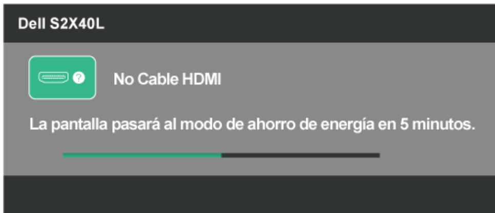
4. Este cuadro también aparece durante el funcionamiento normal del sistema si el cable de vídeo se desconecta o daña. El monitor entrará en el **modo de ahorro de energía después de 5 minutos** si permanece en este estado.
